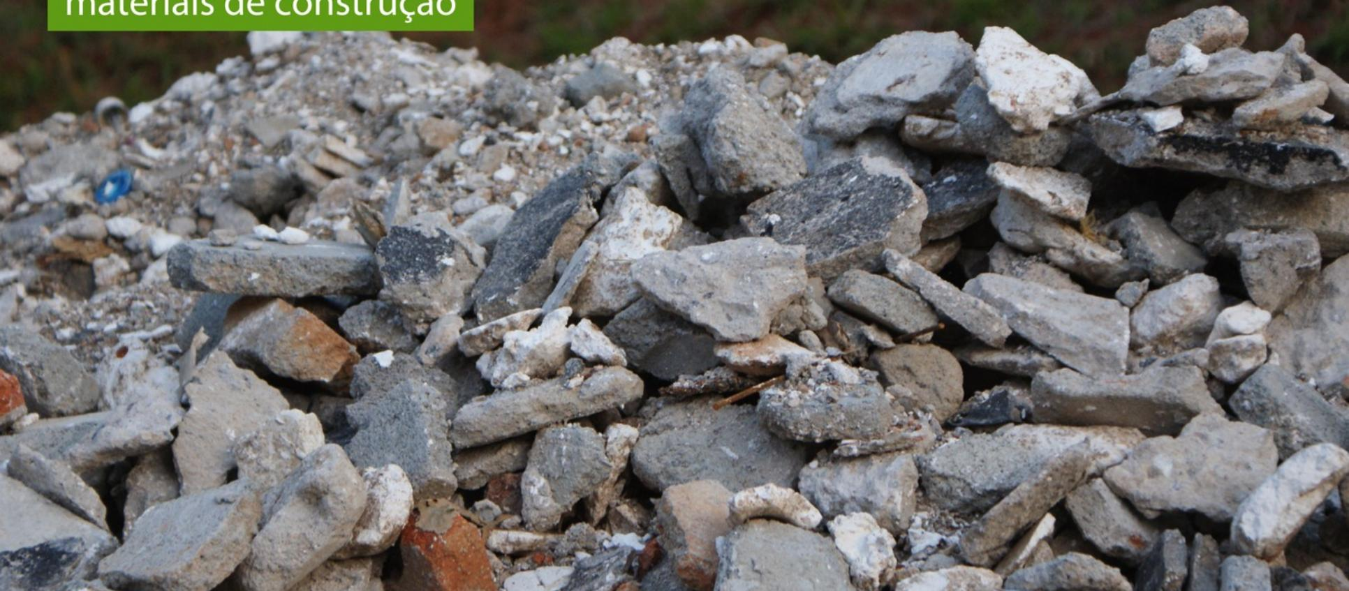
Com recursos do BNDES, o IPT desenvolveu para a InterCement um cimento feito a partir de **Resíduos de Construção e Demolição (RCD)**. Além de diminuir o envio dos RCD para aterros, o material terá custo reduzido e baixo impacto ambiental.
