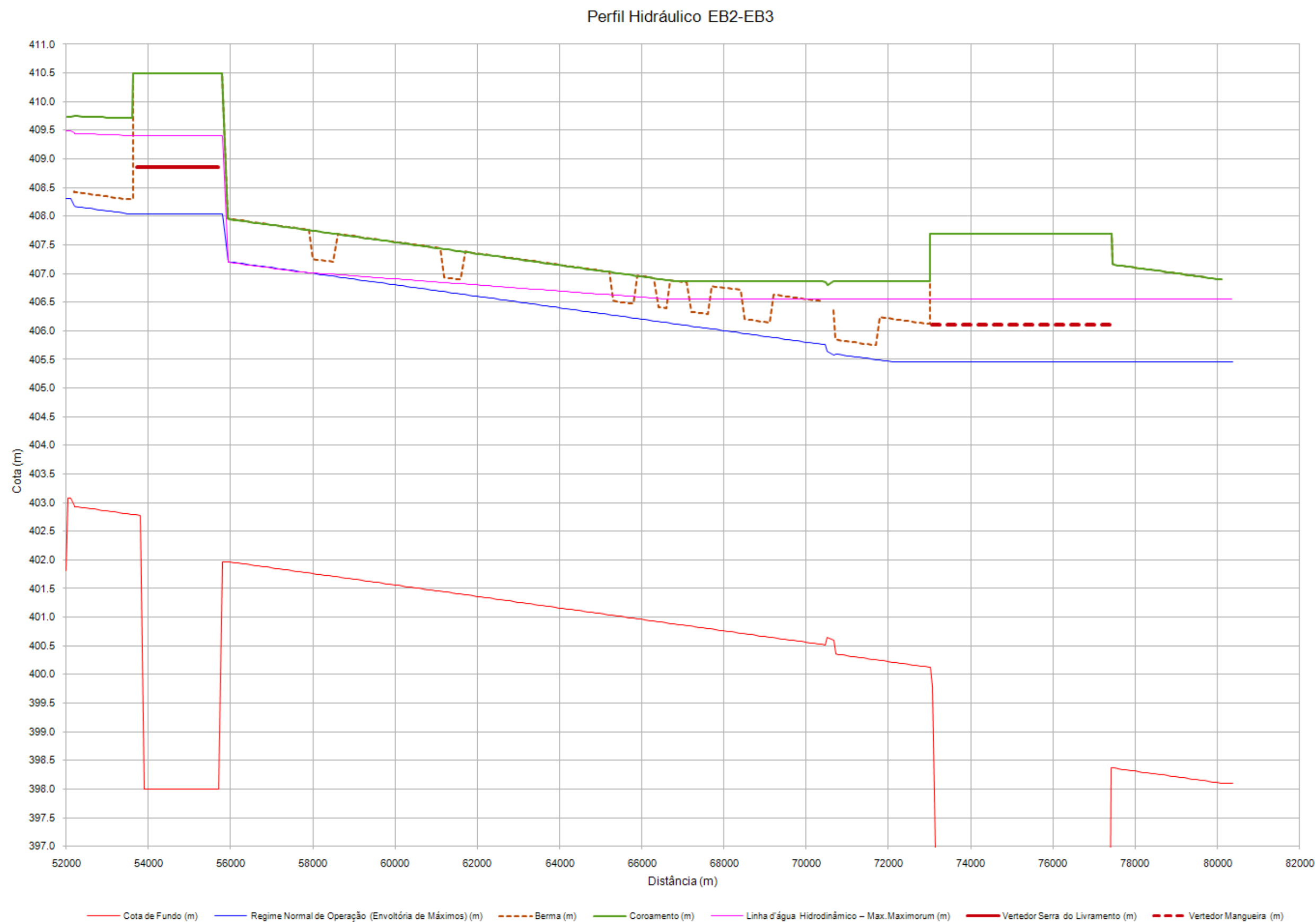
Figura 5.11 - Perfil Hidráulico do Setor B
