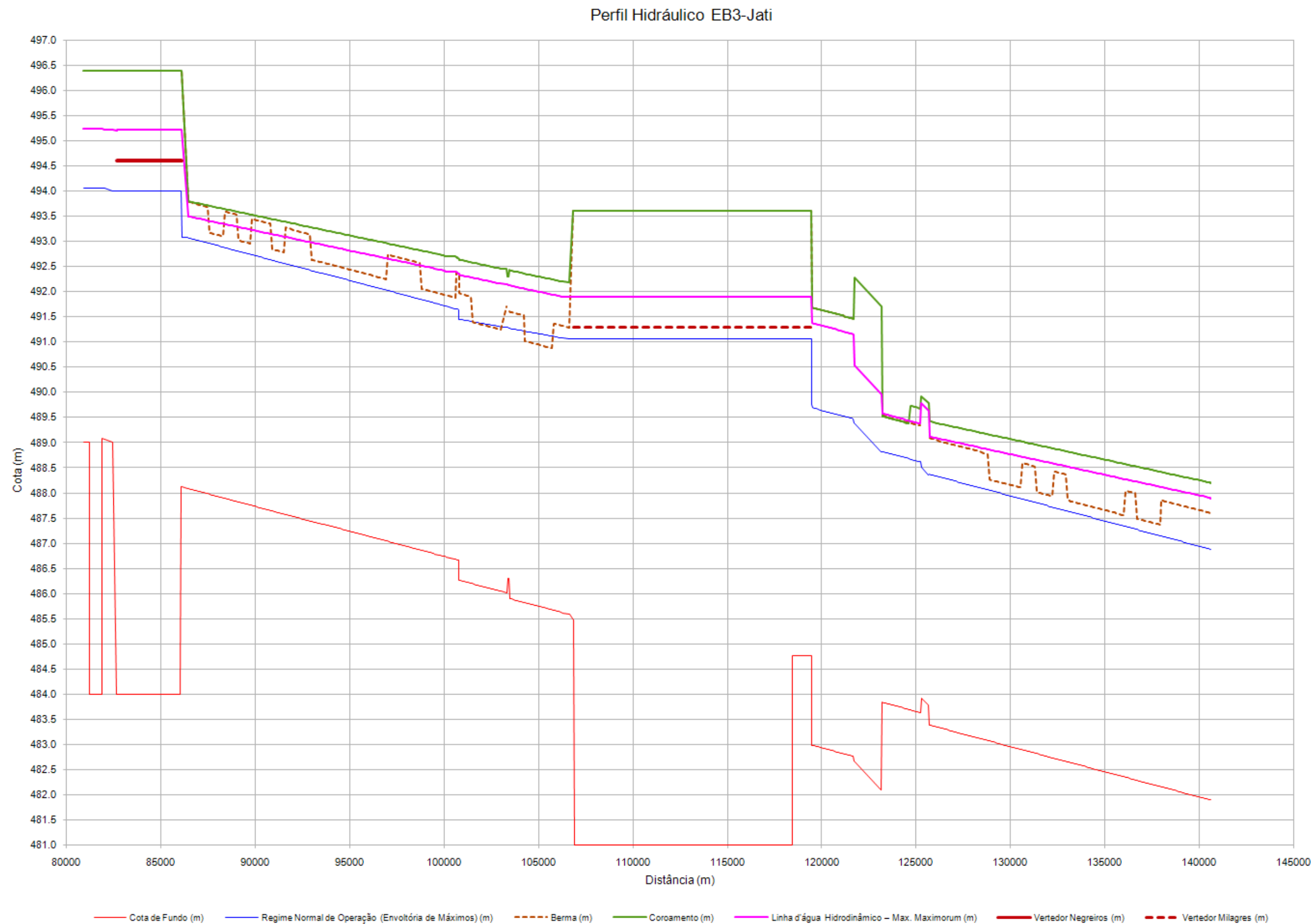
Figura 5.12 - Perfil Hidráulico do Setor C
