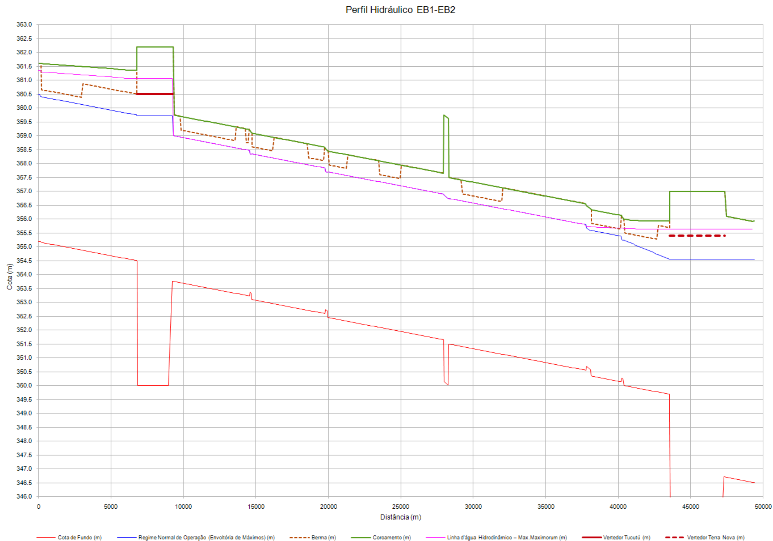
Figura 5.10 - Perfil Hidráulico do Setor A
