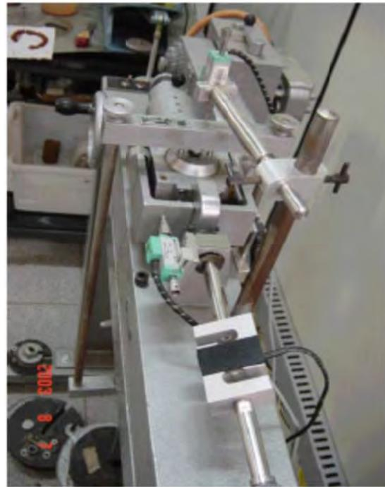
**Figura nº 4.4: Detalhe do Equipamento para Ensaio de Cisalhamento Direto Instrumentado**
